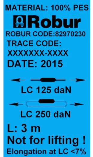
Il colore blu dell'etichetta identifica in maniera immediata il tipo di materiale di cui è composto il nastro, PES 100% (poliestere 100%)
