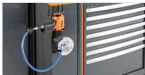
Tomada de ar comprimido com enrolador integrado Ø8 mm, comprimento 10m.
