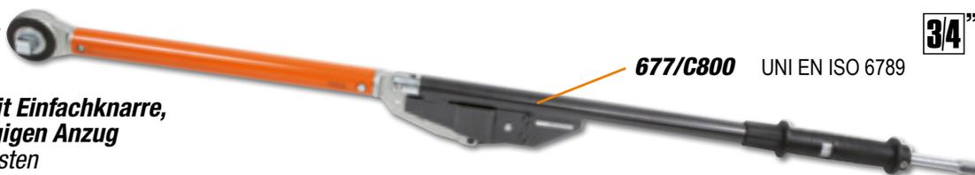
Der Drehmomentschlüssel von Beta 677 eignet sich besonders bei schwierigen Einsätzen mit hohen Anzugsdrehmomenten. Der Auslösemechanismus weist den Bediener durch Biegen des Schlüssels am Drehpunkt um ca. 20° auf das Erreichen des eingestellten Drehmoments hin.
