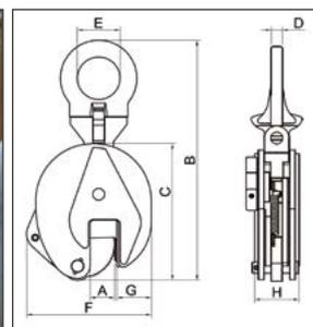
Nicht geeignet zum Anheben von Lasten mit Gewicht unter 10% der max. Nennbelastbarkeit
