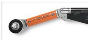
Der Auslösemechanismus weist den Bediener durch Biegen des Schlüssels am Drehpunkt um ca. 20° auf das Erreichen des eingestellten Drehmoments hin.
