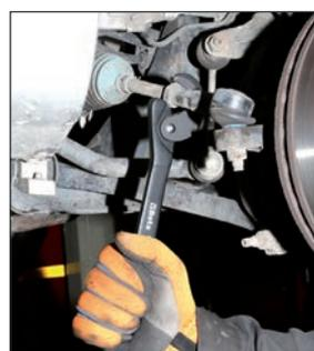
**PUÒ ESSERE IMPIEGATA ANCHE PER IL SERRAGGIO DI VITI USURATE O ROVINATE**
