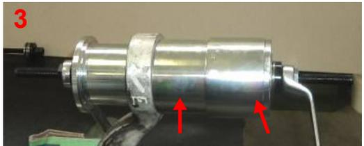
**HINWEIS: Sollte der Silentblock sehr lang sein und ein kompletter Auszug mit einer Buchse nicht möglich sein, ist die Verwendung einer zweiten, dem Kit zu entnehmenden Verlängerungsbuchse erforderlich, bei deren Auswahl darauf zu achten ist, dass sie sich perfekt in die Stufe der zuvor verwendeten Buchse einfügt (Abb. 3).**
