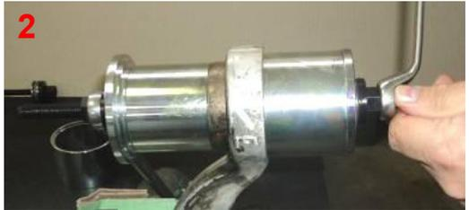
**N.B.:** Het Silent Block is erg lang en met één enkele bus lukt het niet het helemaal te verwijderen. Er moet dus een tweede verlengbus worden gebruikt.
