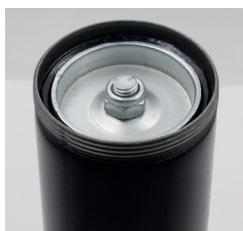
A használt olaj viszkozitásától függően, állítsuk be a kinyomókar fejrészénél található csavart (lásd a képet): különlegesen sűrű folyadék esetén kiengedendő, kevésbé sűrű folyadék esetén meghúzandó.
