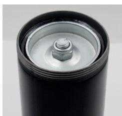
En fonction de la viscosité de l'huile, régler l'écrou présent sur la tête du piston (voir image) : desserré pour les liquides particulièrement denses, plus serré pour les liquides moins denses.
