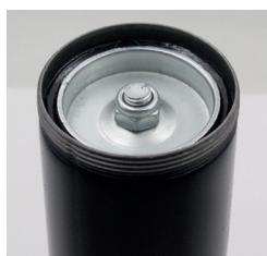
В зависимост от вискозитета на маслото, регулирайте гайката на главата на буталото (вижте изображението): хлабав за особено плътни течности, по-стегнат за по-малко плътни течности.
