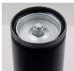
Ανάλογα με το ιξώδες του λαδιού, ρυθμίστε το παξιμάδι που βρίσκετε στην κεφαλή του εμβόλου (βλ. εικόνα): πιο χαλαρό για ιδιαίτερα πυκνά ρευστά, πιο σφιχτό για λιγότερο πυκνά ρευστά.
