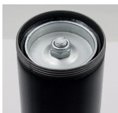
Glede na viskoznost olja nastavite matico na glavi bata (glej sliko): ohlapno za posebej goste tekočine, tesnejše za manj goste tekočine.
