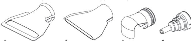
**!** Używając osprzętu D, należy uważać, aby strumień wychodzący z bocznych otworów wentylacyjnych nie powodował szkód wobec osób i przedmiotów w bezpośrednim sąsiedztwie.
