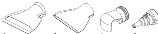
**⚠️** Při používání příslušenství D dbejte na to, aby proud unikající z bočních větracích otvorů nepoškodil osoby a předměty v bezprostřední blízkosti.
