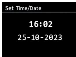
Aby ustawić godziny i minuty, należy przewijać cyfry za pomocą przycisków "TUNE +/TUNE -" i nacisnąć pokrętło, aby wybrać żądaną wartość. Następnie przejdź do następnej ustawianej wartości. Po ustawieniu ostatniej wartości na wyświetlaczu pojawi się potwierdzenie zapisania nowej daty i godziny.
