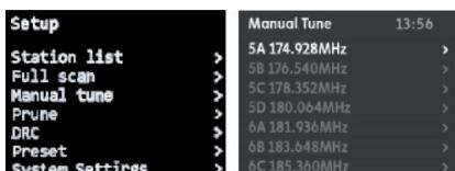
Prüfen Sie die Signalstärke und stellen Sie sicher, dass sie über dem Mindestwert liegt. Drücken Sie schnell auf den Knopf, um die Frequenz zu aktualisieren und zu speichern.
