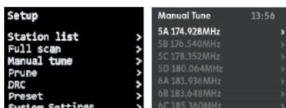
Preverite moč signala in se prepričajte, da je nad minimalno črto. Hitro pritisnite gumb, da posodobite in shranite frekvenco.
