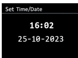
Para ajustar las horas y los minutos, desplácese por los números con los botones "TUNE +/TUNE -" y pulse el dial para seleccionar el valor deseado. A continuación, pase al siguiente valor a ajustar. Una vez ajustado el último valor, la pantalla confirmará que se han guardado la fecha y la hora nuevas.
