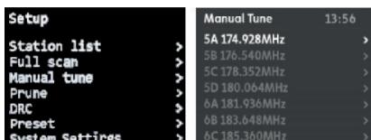
Controllare la potenza del segnale assicurandosi che sia superiore alla barra minima. Premere rapidamente la manopola per aggiornare e memorizzare la frequenza.
