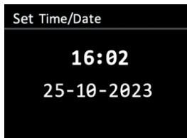
Come per l'impostazione dell'ora e dei minuti, far scorrere i numeri con i tasti "TUNE +/TUNE -" e premere la manopola per selezionare il valore prescelto. Quindi passare al valore successivo da impostare. Una volta impostato l'ultimo valore, il display confermerà che la nuova data e ora sono state salvate.
