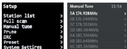
Skontrolujte intenzitu signálu a uistite sa, že je nad minimálnou hodnotou. Rýchlym sťačením gombíka aktualizujte a uložte frekvenciu.
