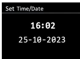
Comme pour le réglage des heures et des minutes, faites défiler les chiffres à l'aide des touches "TUNE +/TUNE -" et appuyez sur le cadran pour sélectionner la valeur souhaitée. Passez ensuite à la valeur suivante à régler. Une fois la dernière valeur réglée, l'écran confirme que la nouvelle date et l'heure ont été sauvegardées.
