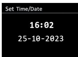
Voor het instellen van de uren en minuten scrollt u door de getallen met de knoppen "TUNE +/TUNE -" en drukt u op de draaiknop om de gewenste waarde te selecteren. Ga vervolgens naar de volgende in te stellen waarde. Zodra de laatste waarde is ingesteld, bevestigt het display dat de nieuwe datum en tijd zijn opgeslagen.
