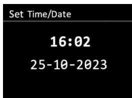
Pokiaľ ide o nastavenie hodín a minút, prechádzajte číslami pomocou tlačidiel "TUNE +/TUNE -" a stlačením voliča vyberte požadovanú hodnotu. Potom prejdite na ďalšiu nastavovanú hodnotu. Po nastavení poslednej hodnoty sa na displeji zobrazí potvrdenie, že nový dátum a čas boli uložené.
