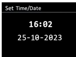
Pokud jde o nastavení hodin a minut, procházejte čísla pomocí tlačítka "TUNE +/TUNE -" a stisknutím voliče vyberte požadovanou hodnotu. Poté přejděte na další nastavovanou hodnotu. Po nastavení poslední hodnoty se na displeji zobrazí potvrzení, že nové datum a čas byly uloženy.
