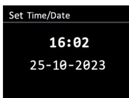
Når du skal indstille timer og minutter, skal du rulle gennem tallene med knapperne "TUNE +/TUNE -" og trykke på drejeknappen for at vælge den ønskede værdi. Gå derefter videre til den næste værdi, der skal indstilles. Når den sidste værdi er indstillet, vil displayet bekræfte, at den nye dato og det nye klokkeslæt er blevet gemt.
