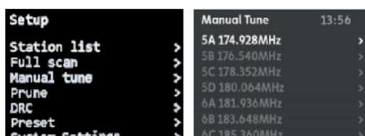
Compruebe la intensidad de la señal asegurándose de que está por encima de la barra mínima. Pulse rápidamente el mando para actualizar y almacenar la frecuencia.
