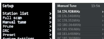
Sprawdź siłę sygnału, upewnijąc się, że jest powyżej minimalnego paska. Szybko naciśnij pokrętło, aby zaktualizować i zapisać częstotliwość.
