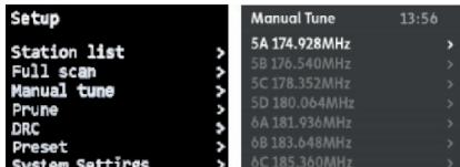
Vérifiez l'intensité du signal en vous assurant qu'elle est supérieure à la barre minimale. Appuyez rapidement sur le bouton pour mettre à jour et enregistrer la fréquence.
