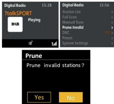
Nachdem Sie den Sender, den Sie entfernen möchten, ausgewählt haben, wählen Sie in den MENÜ-Optionen die Option "Prune". Sie haben die Wahl zwischen "Ja" und "Nein". Wählen Sie "Ja", um den Sender zu entfernen. Verwenden Sie die Tasten Tune+/-, um durch die Optionen zu blättern und drücken Sie das Rad zur Bestätigung.
