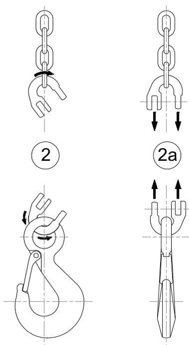
Inserire il sistema di aggancio dell'elemento da sollevare nella sede del gancio spingendo verso l'interno il dispositivo di chiusura dell'imbocco, il quale ritorna automaticamente nella posizione di chiusura dopo l'inserimento, spinto dalla forza della molla.
