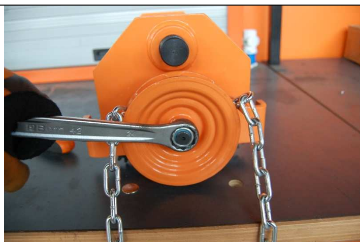
Svitare il dado che blocca la ruota di manovra.
