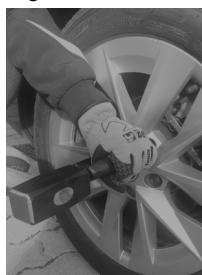
A este punto puede proceder con la retirada del perno mediante 3 herramientas diferentes:
