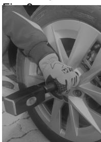
Nun ist es möglich, mittels 3 unterschiedlichen Werkzeugen mit dem Entfernen des Bolzens zu beginnen:
